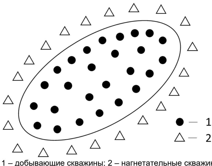
Рисунок 2.1 – Принципиальная схема законтурного заводнения
